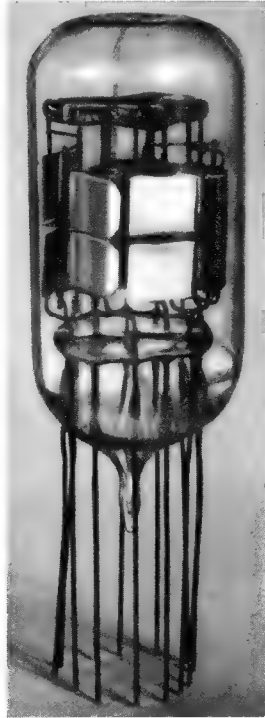
Bild 1. Außenansicht des achtstufigen Zweibahn-Sekundärelektronen-Vervielfachers
