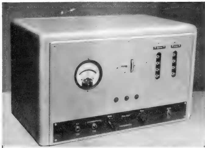
Bild 12. Ein industriell hergestellter Geiger-Müller-Zähler, (Ing. F. Schreib, Wien). In den schwarzen Schlitzen sind die Interpolations-Glimmlämpchen sichtbar
